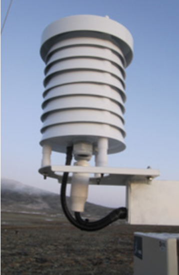
Temperaturhytte på Snøheim vær- stasjon. Foto: Scanmatic AS
